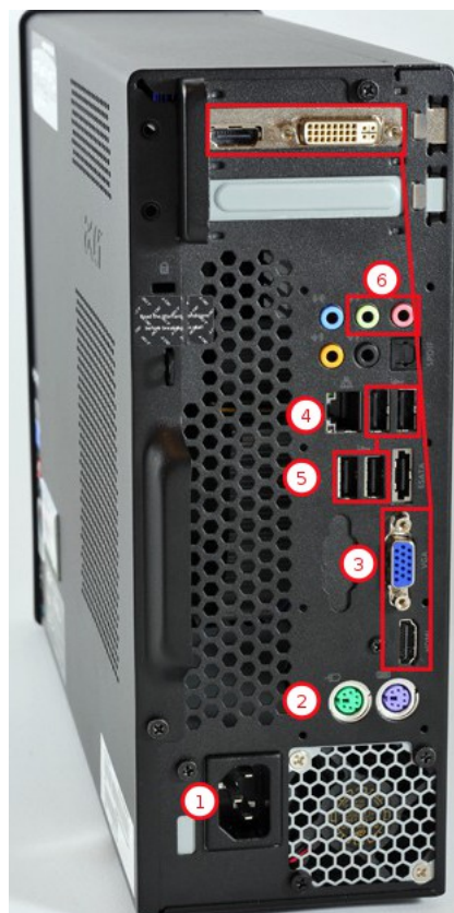
FIGURE 4 – L'arrière d'une unité centrale
